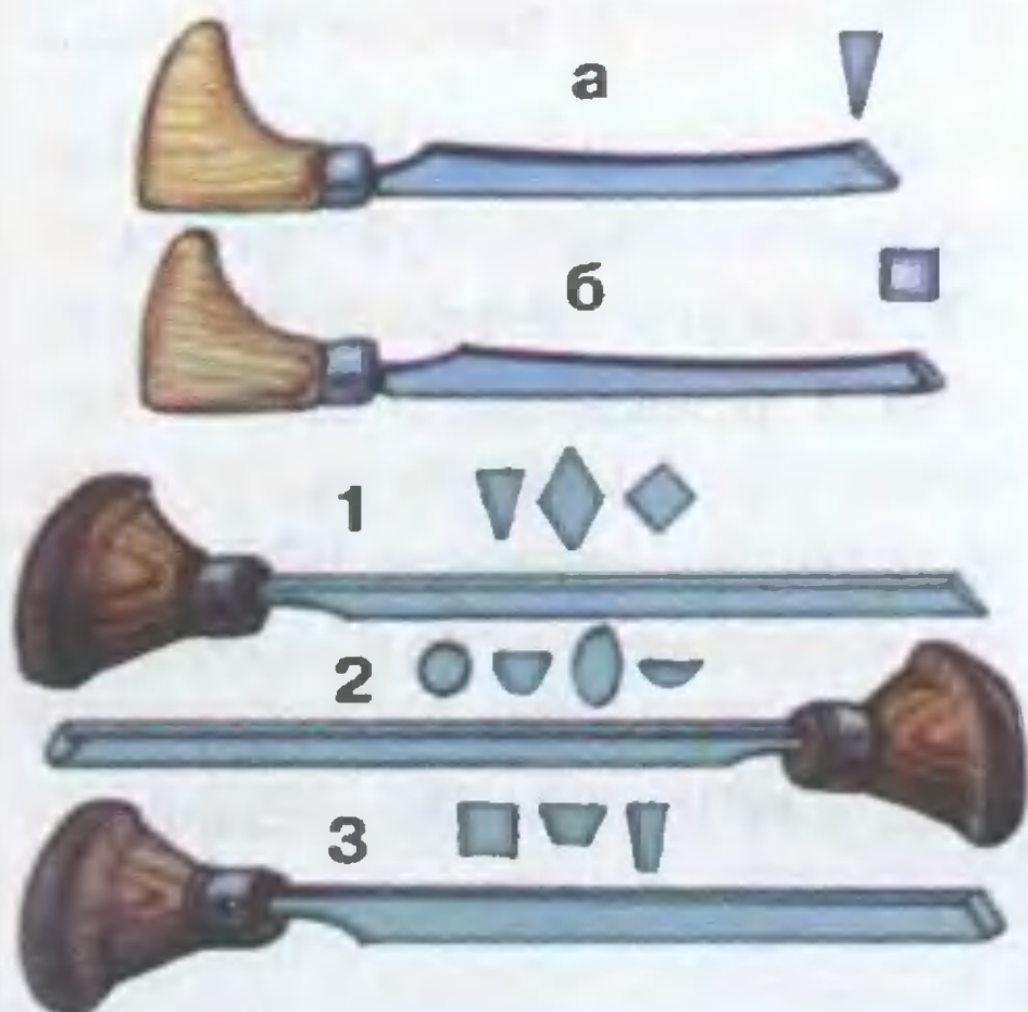
Рис. 1. Инструменты для гравировки: а, б — штихели для штриховой гравировки, 1 — грабштихель, имеющий
